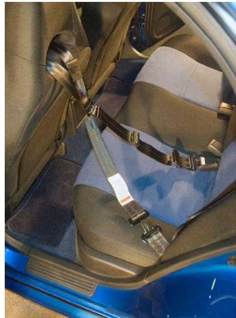
**i. 3 QuickFit® – Clip-In/Clip-Out attachment points**
